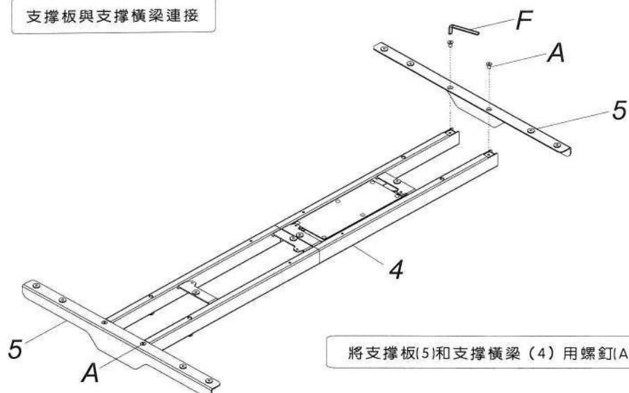
將支撑板(5)和支撑横梁(4)用螺釘(A)連接，并用扳手(F)鎖緊。
