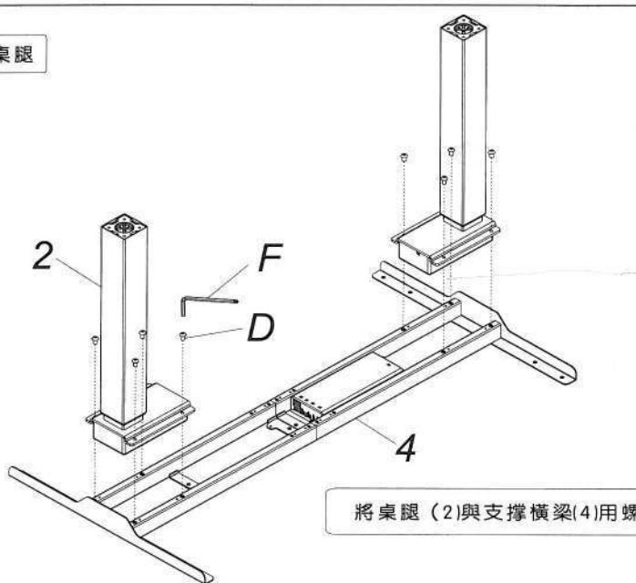
將桌腿(2)與支撑横梁(4)用螺釘(D)連接，并用扳手(F)鎖緊。
