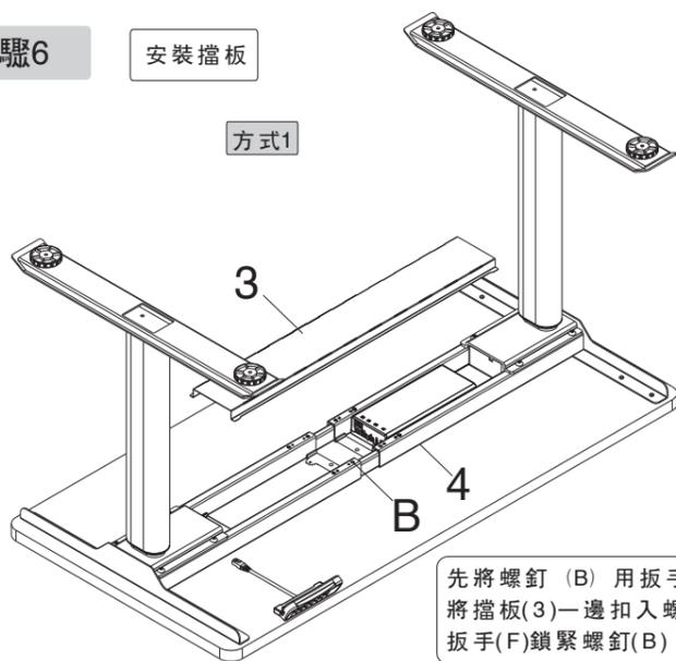
先將螺釘 (B) 用扳手(F)擰入支撐橫梁 (4) 上，不完全擰緊，將擋板(3)一邊扣入螺釘(B)內，另一邊也壓入螺釘(B)內，最後用扳手(F)鎖緊螺釘(B)
