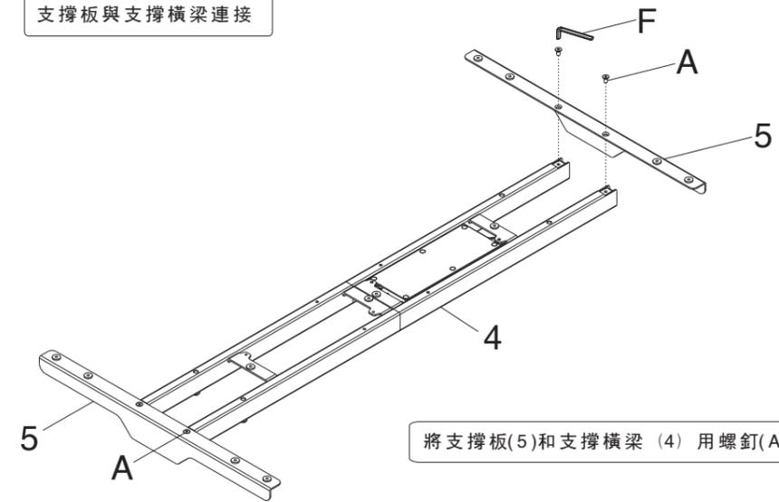
將支撐板(5)和支撐橫梁(4)用螺釘(A)連接,并用扳手(F)鎖緊。
